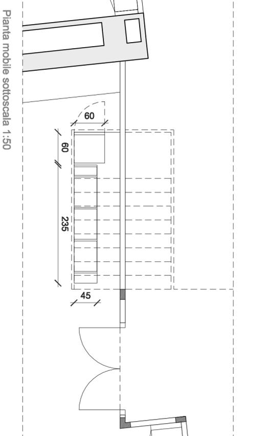
Pianta mobile sottoscala 1:50
