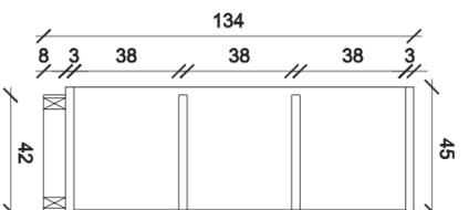
Sezione mobile sottoscala 1:20
